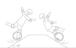
Не передвигайтесь на Моноколесо по поверхностям с уклоном более 15 градусов. Это может привести к падению вследствие перегрузки моноколеса.
