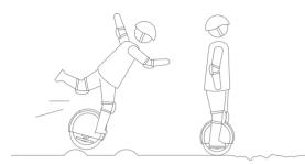
При движении по неровной, ухабистой поверхности не следует резко разгоняться или тормозить, это может привести к заносу. Двигайтесь на скорости 3-10 км/ч, немного согнув колени.
